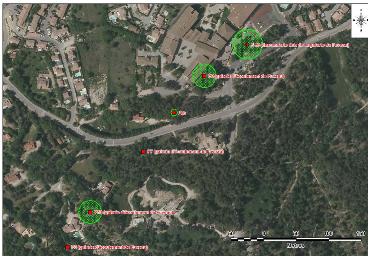
Figure 7 : Extrait de la révision de la carte d'aléa effondrement localisé lié aux ouvrages débouchant au jour sur la commune de Fuveau – Fond BD Ortho IGN (PVA 2011) (zone en pointillés verts : aléa effondrement localisé faible)
