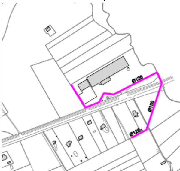
Réseau d'eau potable
